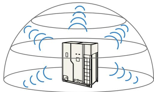
音源が周囲に発する全音響エネルギーを測定するので、運転音の大きさにより一義的に決まる
