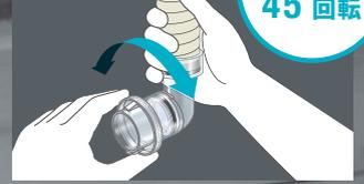
フランジ直付け後にドレンホースを差込むだけ。施工の手間を大幅に短縮できます。※1
