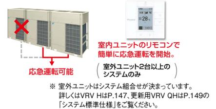
●システム内の室外ユニットの主機を8時間ごとにローテーションする事で、低負荷時に1ユニットに集中する負担を分散し、システム全体の長寿命化を図っています。(室外ユニット2台以上のシステム)
