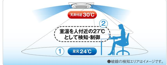
① 床温度センサーが天井付近よりも温度が低い床面温度を検知。
